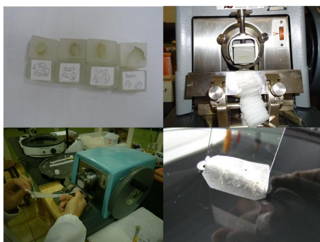
Figura 1. Blocos de Paraplast® contendo os fragmentos de folhas, micrótomo rotatório e montagem das lâminas nas dependências do laboratório de bromatologia da UFGD. (Fonte: Basso, K.C. Arquivo pessoal).
