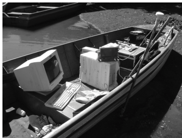
Figura 3. A) Ecossonda modelo Furuno GP-1650F, B) Sistema de Posicionamento Global (GPS), acoplados a um computador utilizado na realização do levantamento batimétrico.
