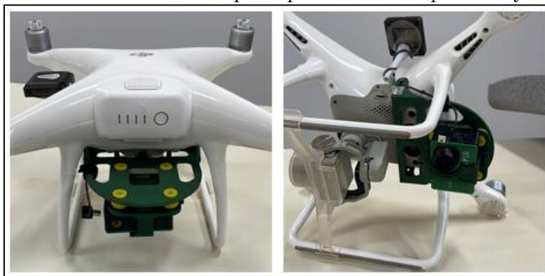
Figura 2 - Phantom 4 PRO com suporte para câmera Mapir Survey 3w (OCN)
