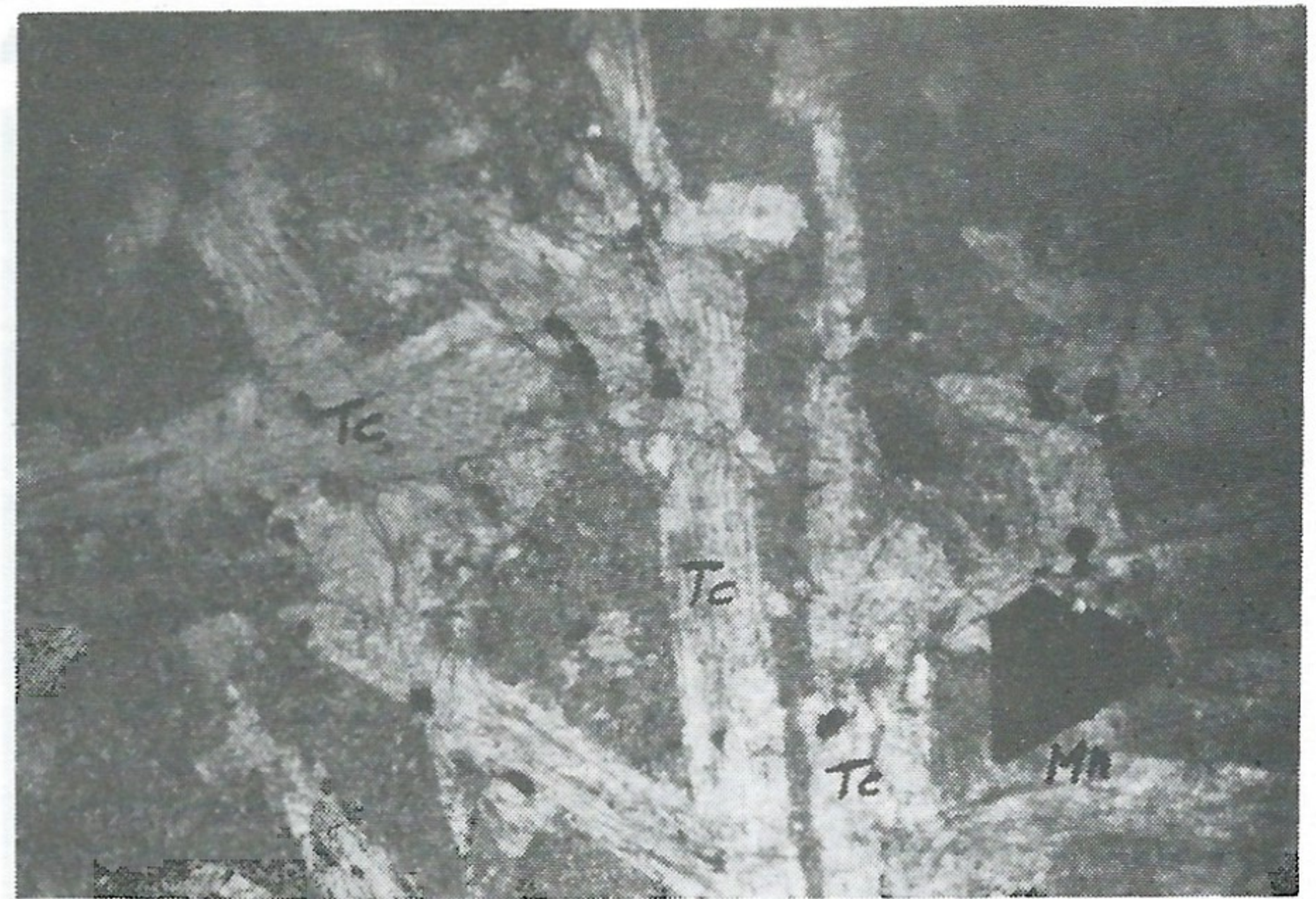
Foto 5 - Talco-clorita xisto apresentando textura pseudo-spinifex, com pseudomorfos aciculares de talco (Tc) sobre matriz clorítica. L P Mn magnetita
