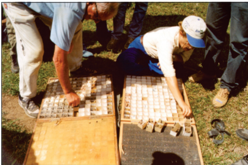
Figura 4 – Pedocomparador utilizado para amostras coletadas nas tradagens
