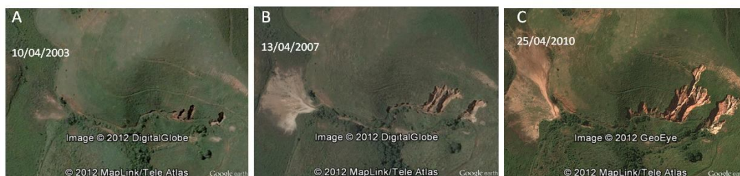
Figura 1: Evolução de um processo de voçoracamento no município de Macaé (RJ), registrado por imagens de alta resolução em três etapas: (A) Início do processo em 2003. (B) Evolução da frente erosiva e formação de cone de ejeção na base do morro em 2007. (C) Aprofundamento e alargamento da feição erosiva com aumento do cone de ejeção na base do morro em 2011. Fonte: Google Earth™ .
