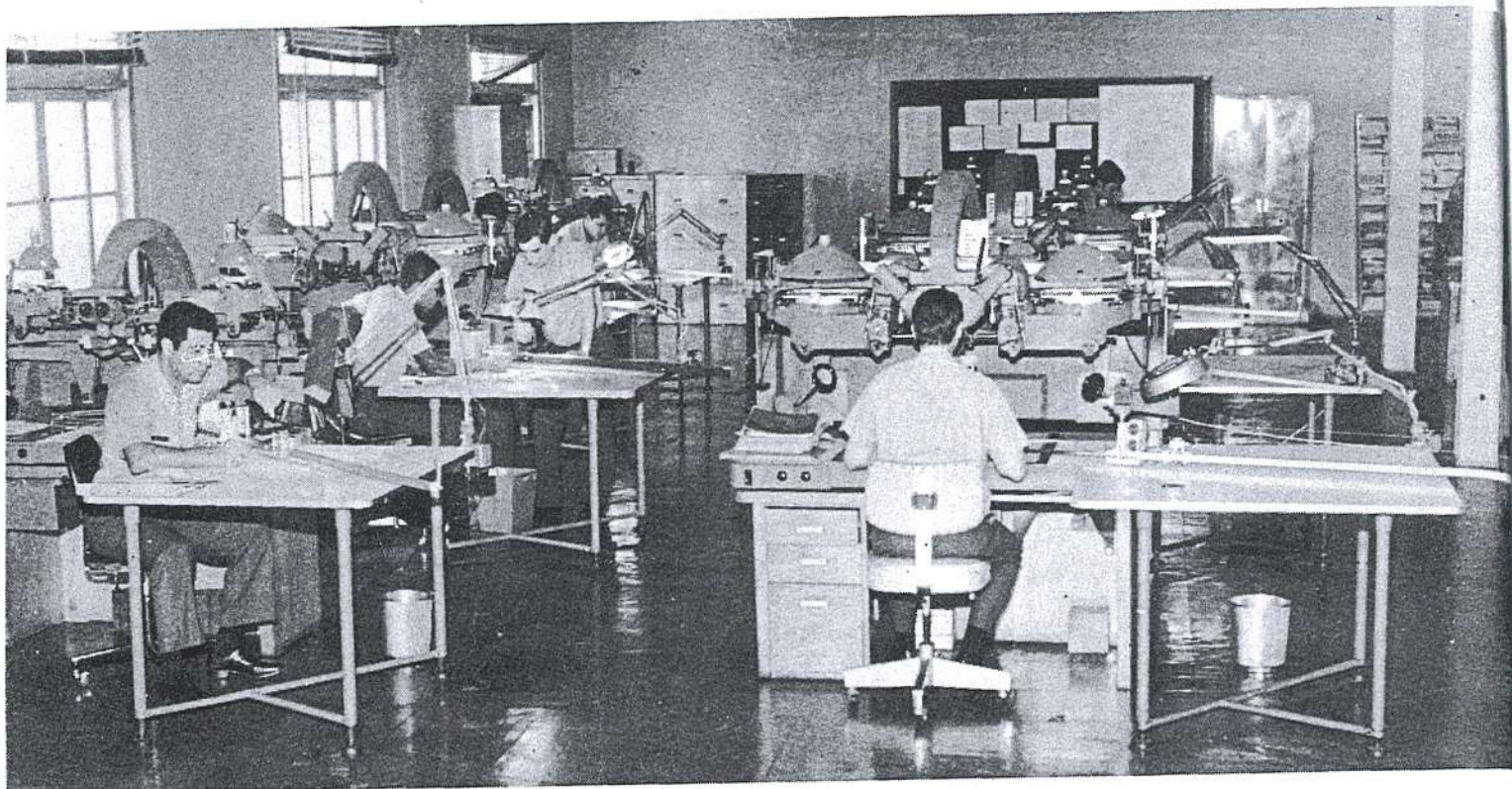
Visão panorâmica da sala de aparelhos restituidores do Centro de Operações Cartográficas. Nestes aparelhos realiza-se o desenho inicial da carta partindo-se das fotografias aéreas.
