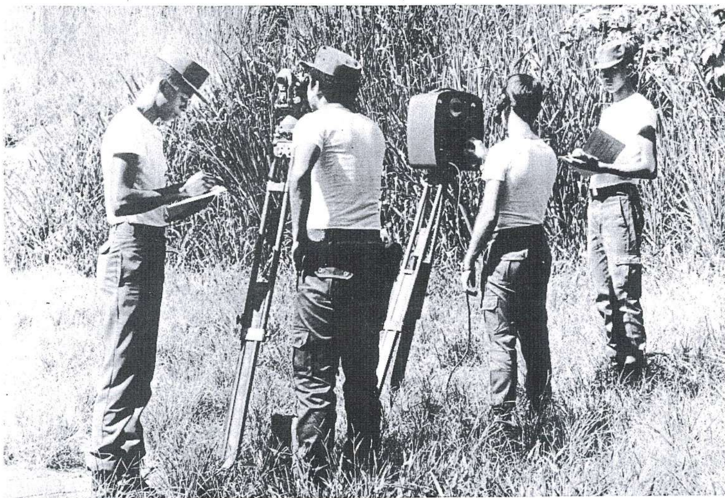
A fotografia registra uma operação simultânea de medida de ângulos com um teodolito (instrumento ótico), à esquerda, e de medida de distâncias com um distanciômetro eletrônico, à direita.
