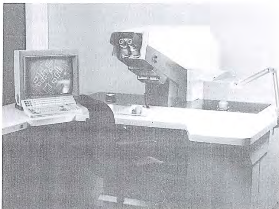
Estação de trabalho integrada ao restituidor analítico
