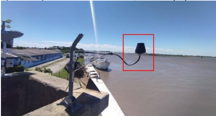
Figura 2 - Instalação da estação GNSS-R em Rio Grande, com destaque para a antena (vermelho).
