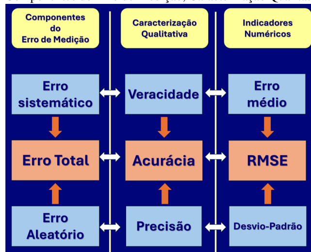
Figura 11 – Componentes do Erro de Medição, Caracterização Qualitativa e Métricas.
