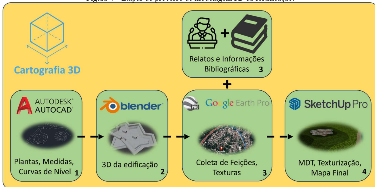
Figura 4 – Etapas do processo de modelagem 3D da fortificação.
