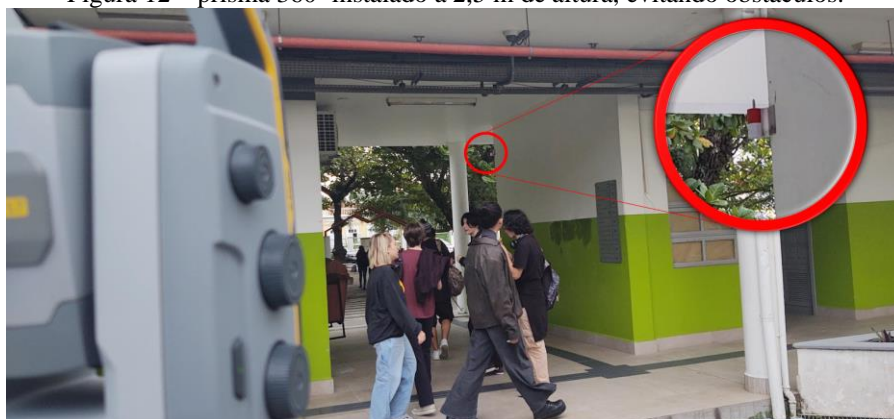
Figura 12 – prisma 360° instalado a 2,5 m de altura, evitando obstáculos.
