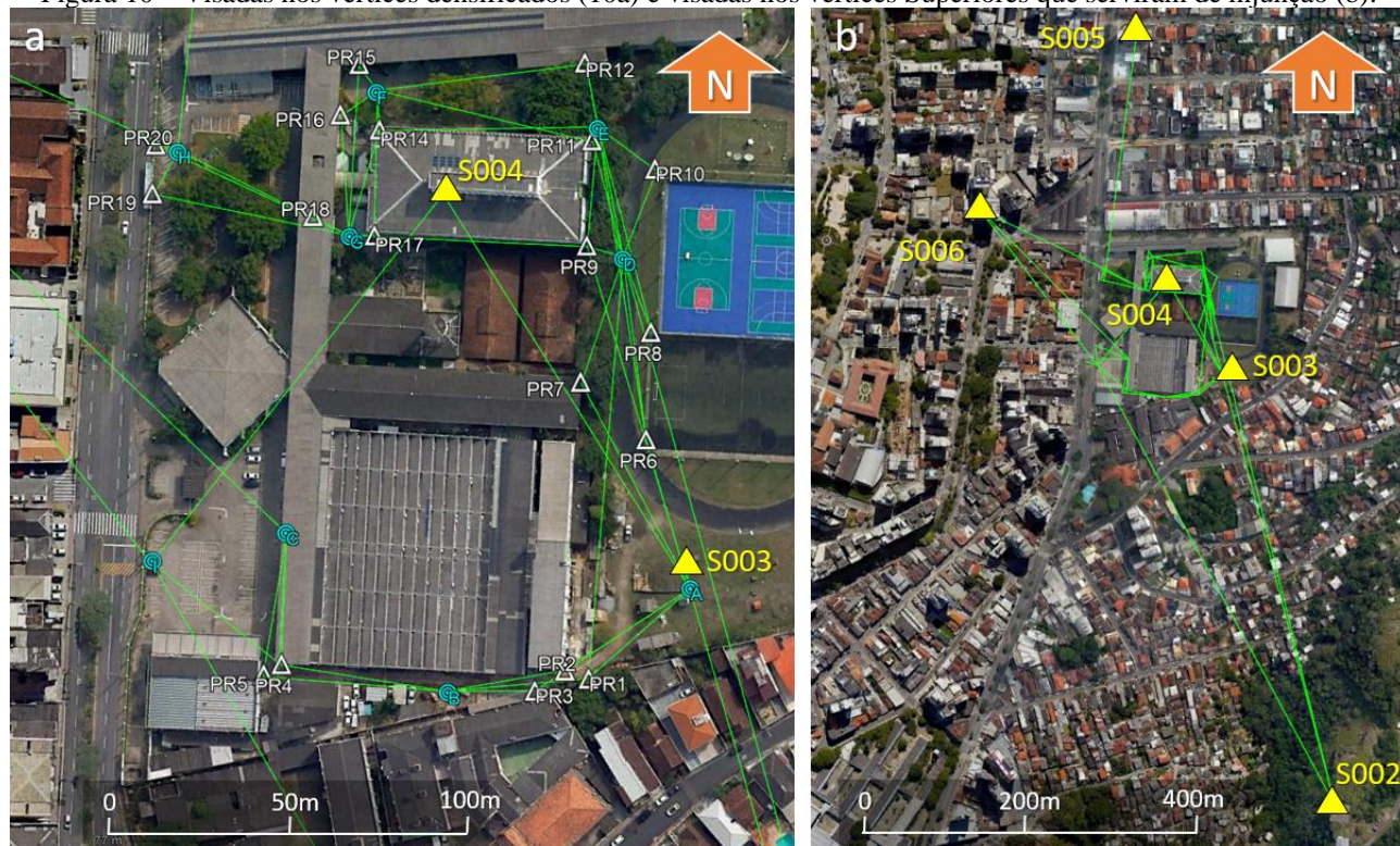
Figura 10 – Visadas nos vértices densificados (10a) e visadas nos vértices Superiores que serviram de inunção (b).
