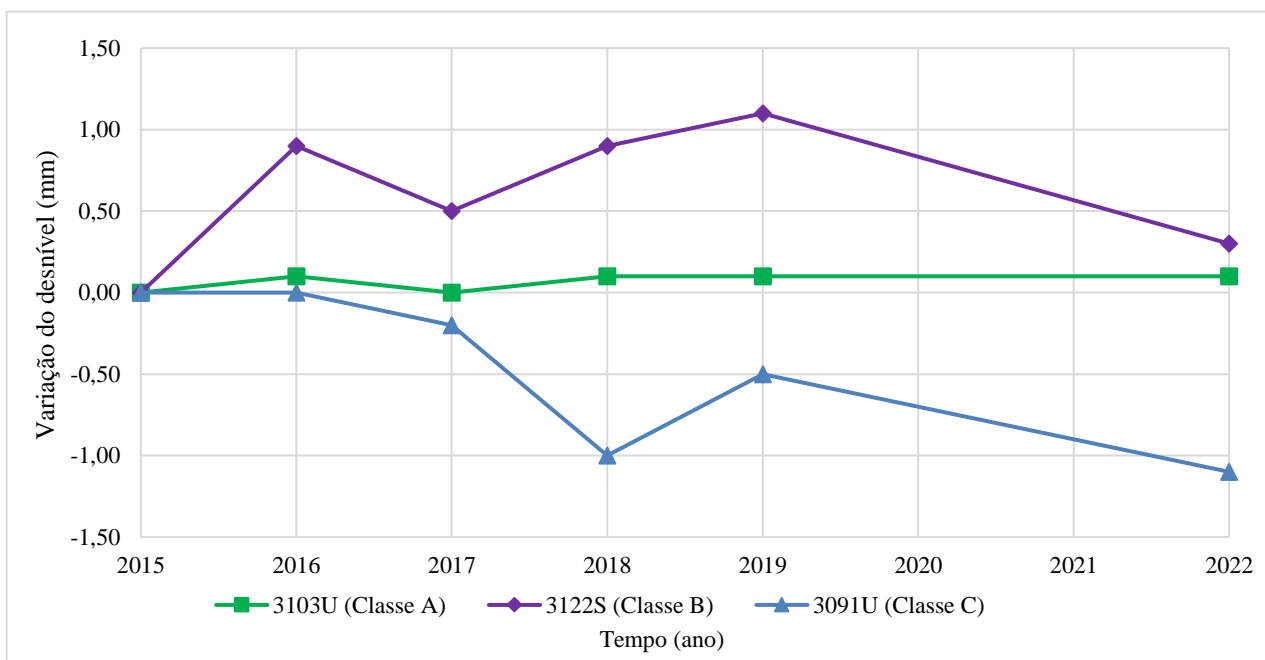
Figura 5 – Variação vertical reduzida de exemplares de referências de nível de cada classe na Estação Maregráfica de Imbituba (SC) no período
