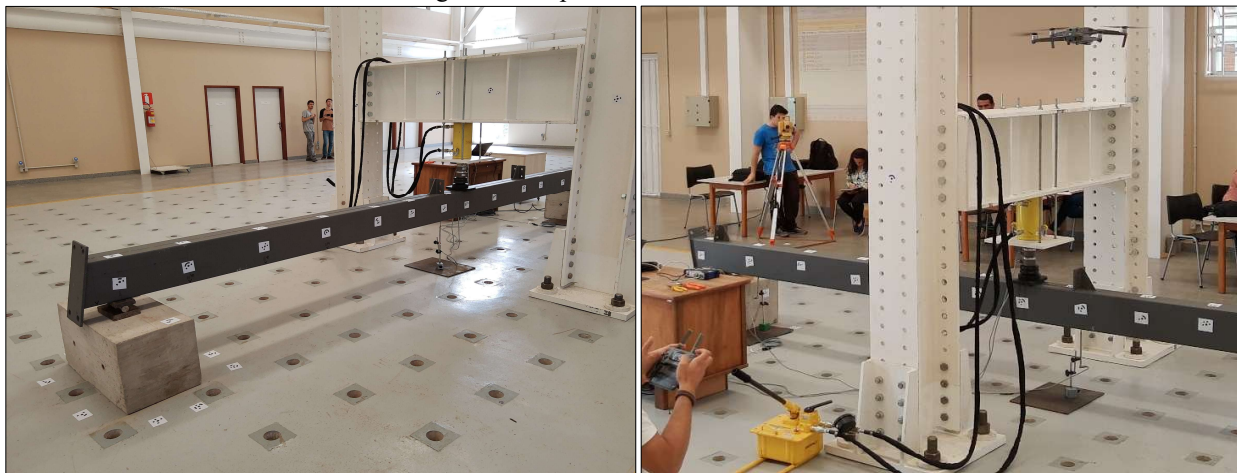
Figura 2 – Aspecto do ensaio de flexão.
