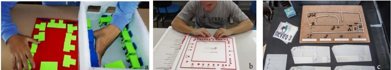
Figura 8 - Documentos Cartográficos táteis produzidos com impressora 3D: (a) mapa e maquete de sala de aula; (b) simbologia para mapa tátil; (c) mapas táteis para orientação e mobilidade.
