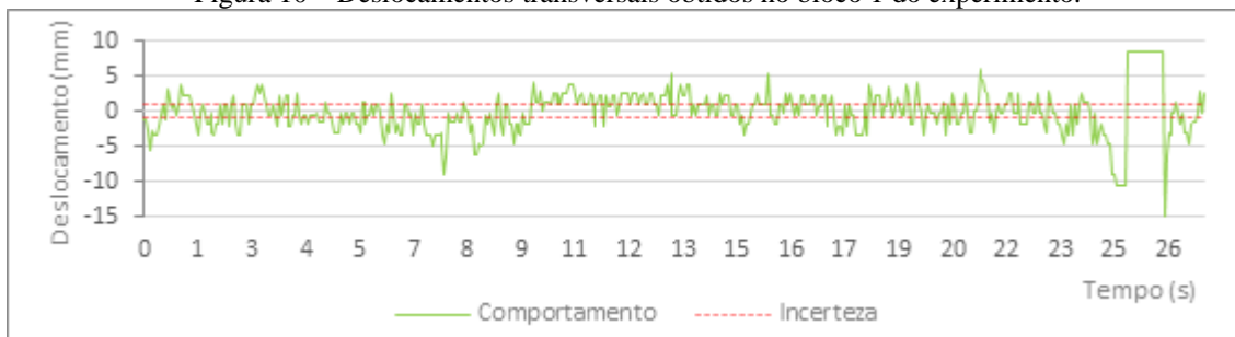
Figura 10 – Deslocamentos transversais obtidos no bloco 1 do experimento.
