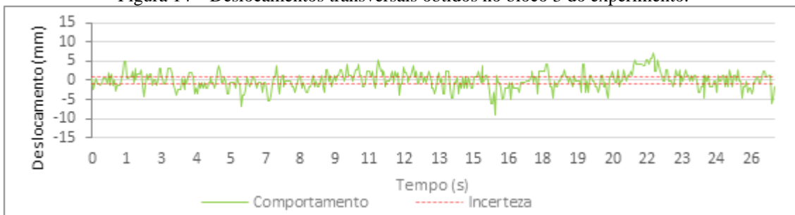
Figura 14 – Deslocamentos transversais obtidos no bloco 3 do experimento.
