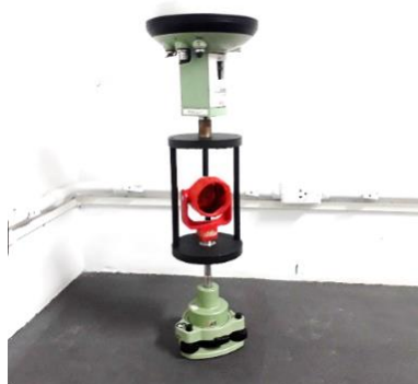
Figura 3 – Suporte para prisma e antena GNSS sobre base nivelante.
