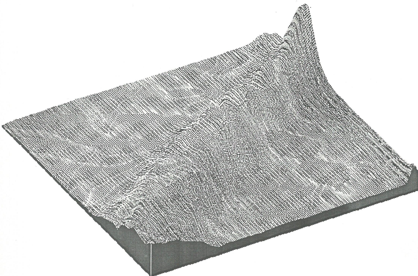
Figura 18 – Modelo tridimensional para o istmo da Ilha do Mel gerado a partir das coordenadas obtidas em tempo real pelo GNRT-K.
