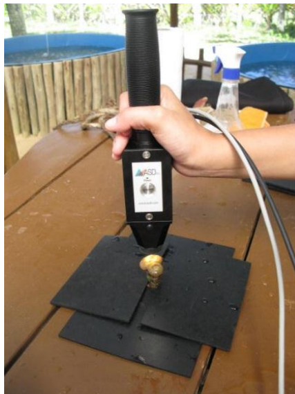
Figura 3- Medições realizadas no coral branqueado Mussismilia harttii utilizando o espectrorradiômetro FieldSpec® 3 Hi-Res, com destaque ao ASD Contact Probe em que estava acoplado o cabo de fibra ótica e a fonte de iluminação.
