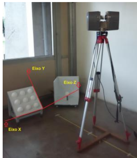
Figura 18 – Sistema de Eixos da Placa de Esferas 3D.
