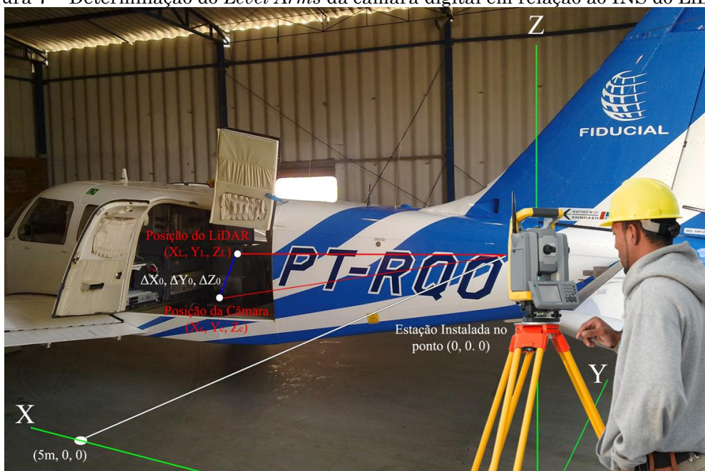
Figura 7 – Determinação do Level Arms da câmara digital em relação ao INS do LiDAR.
