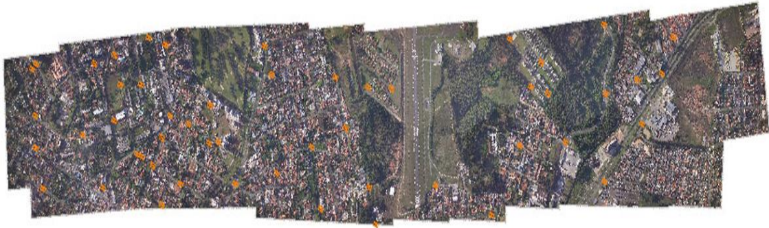
Figura 6 – Os pontos em alaranjando é a localização dos alvos na área de pesquisa na ortofotos resultante do processo de integração.
