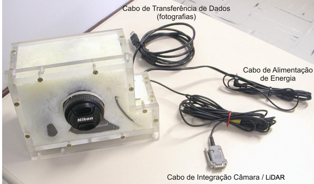
Figura 3 – Caixa de fixação com espuma de Poliuretano e cabos de conexão com o INS.
