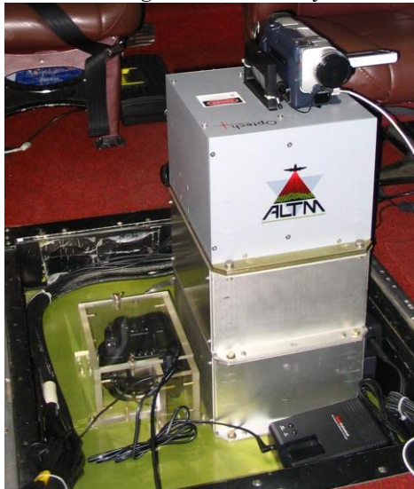
Figura 5 – Montagem da câmara junto ao Lidar.
