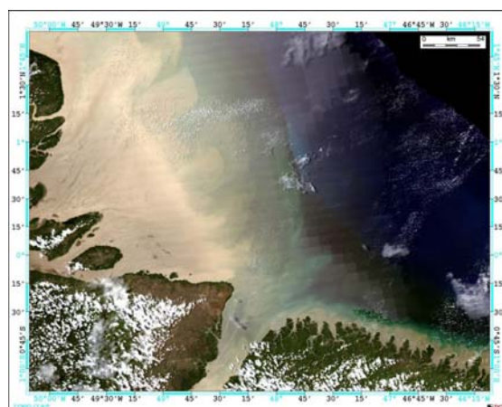
Fig. 4 - Imagem do sensor MODIS a bordo do satélite AQUA na composição 1R4G3B, adquirida em setembro de 2003 mostrando a distribuição dos sedimentos em suspensão na foz do Rio Amazonas.
