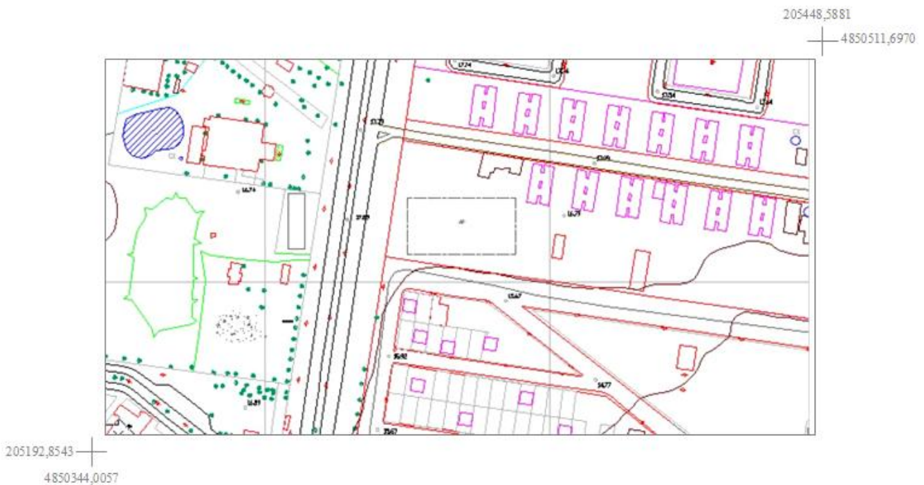
Fig.3 - Fragmento da Carta de Belém após a Edição. (Escala: 1:2000, Projeção LTM, Datum: SAD-69)
