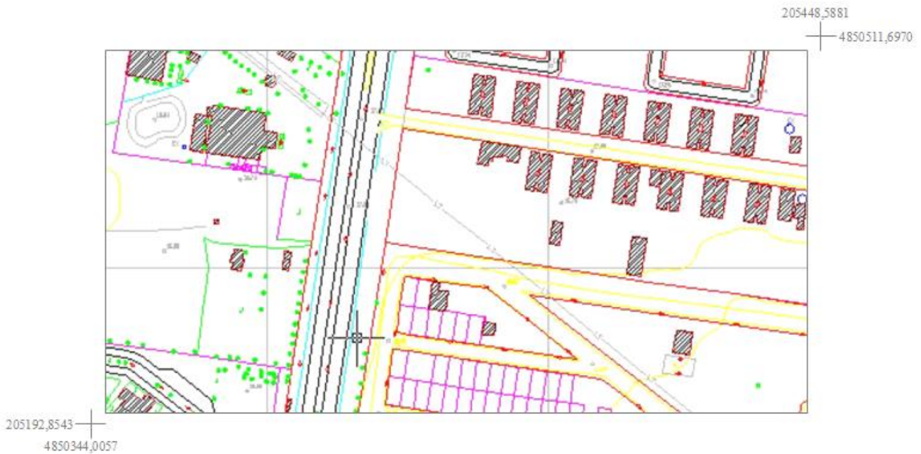
Fig.2 - Fragmento da Carta de Belém-PA antes da Edição. (Escala: 1:2000, Projeção LTM, Datum: SAD-69)
