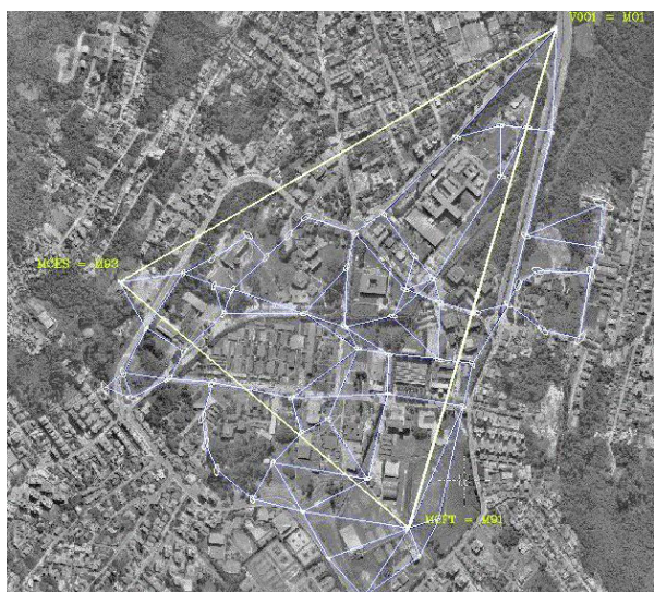
Fig.1 - Visualización de la base geométrica instalada en 1998 en el campus de la UFSC
