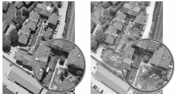
Fig. 1 - Comparação entre um negativo digitalizado e uma imagem digital. Fonte: GRUBER *et al.*, 2003
