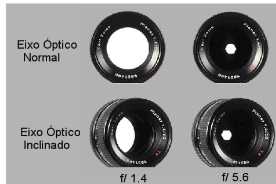
Fig. 1. O vinheta óptico é provocado pelas aberturas maiores do diafragma e pela profundidade do cone que impedem aos raios oblíquos de atingirem uniformemente todo o negativo. Adaptado de (WALREE, 2007).
