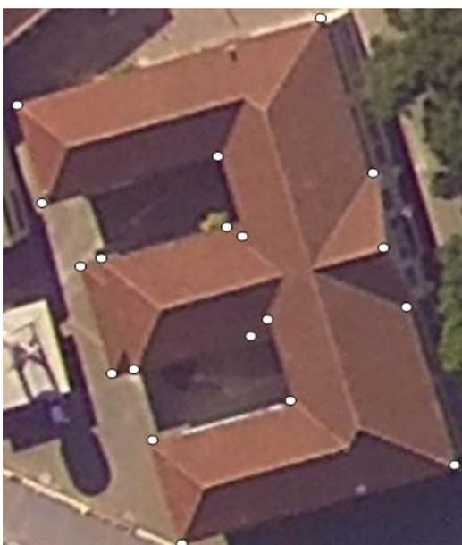
Fig. 4 – Edifício teste 3 com as localizações aproximadas dos vértices do contorno extraído dos dados de VLA.
