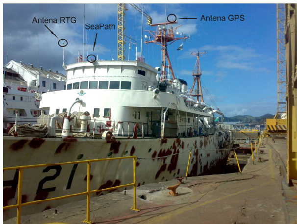
Fig. 2 – Localização de Alguns Sensores no Navio SIRIUS. Fonte: Nardez (2010).
