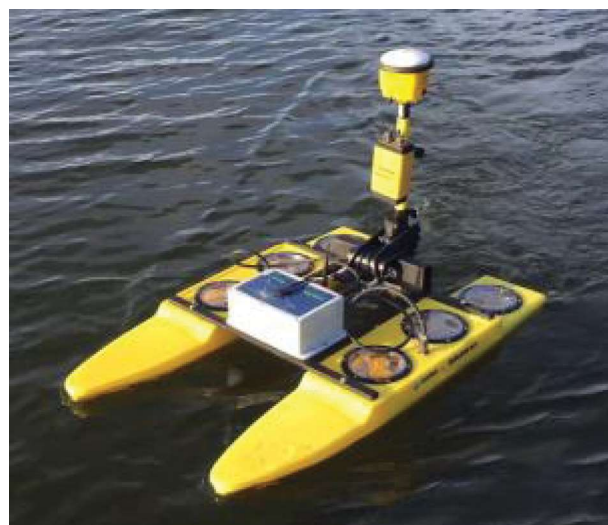
Fig. 5 – ASC Hydron da Seafloor Systems, Inc. equipado com sistema de controle AutoNav, ecobatímetro monofeixe HydroLite e sistema de posicionamento RTK.
