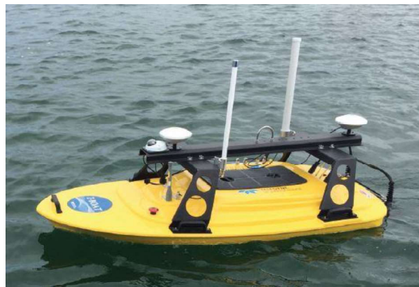
Fig. 7 – ASC Z-Boat 1800-RP da Teledyne Oceanscience equipado com sistema de controle autônomo, ecobatímetro multifeixe, IMU e duas antenas GNSS para posicionamento e heading .
