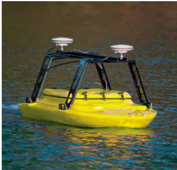
Fig. 6 – ASC Echoboat da Seafloor Systems, Inc. equipado com sistema de controle AutoNav, ecobatímetro multifeixe, IMU e duas antenas GNSS para posicionamento e heading .
