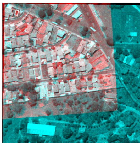
Fig. 6 - Modelo anaglifio da área teste 1 – Imóveis com acréscimo de área construída aparecem em regiões com predominância de vermelho
