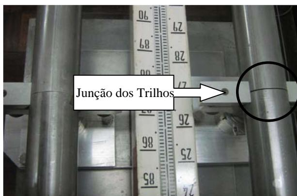
Figura 7 – Detalhe das junções dos trilhos, explicitada nos levantamentos efetuados.
