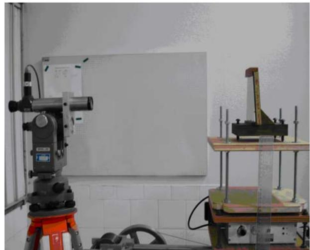
Figura 2 – Sistema utilizado na autocolimação.
