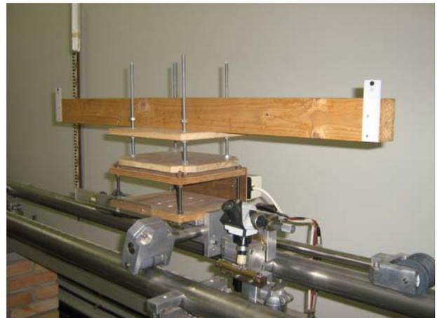
Figura 4 - Montagem de barra horizontal adaptada para o nivelamento dos trilhos.
