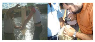
Figura 1: utilização da garrafa de Van Dorn e rede de arrasto planctônica cônica de 40µm de abertura de malha na filtração de 100 litros de água.
