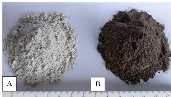
Figura 5 - Resíduos grits (A) e dregs (B) após o processo de moagem Fonte: Os autores (2021)
