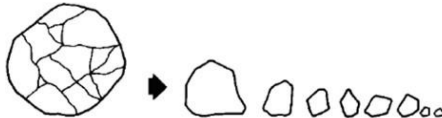
Figura 4 - Representação da fragmentação de partícula com mecanismo de fratura por impacto Fonte: Kelly e Spottswood (1982) apud Nunes (2012)
