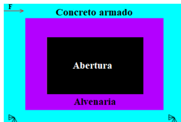
Figura 2 - Modelo de pórtico preenchido isolado simulado pelo MEF
