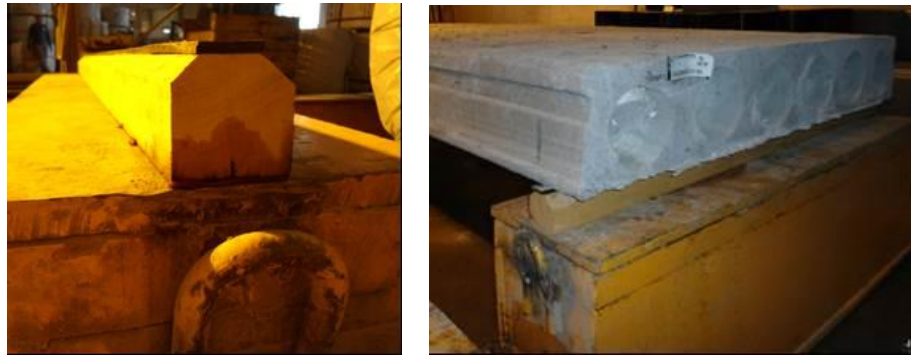
Figura 12 - Detalhe dos apoios utilizados no ensaio (Pinheiro, 2014)
