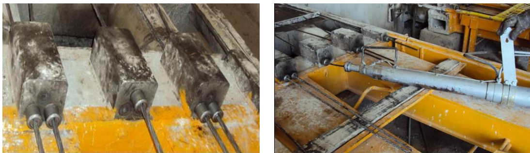
Figura 7 - Etapa de protensão das cordoalhas (Pinheiro, 2014)
