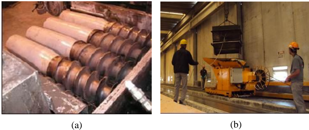
Figura 8 - Sistema de produção de laje alveolares por extrusão: (a) França (2012) e (b) Pinheiro (2014)
