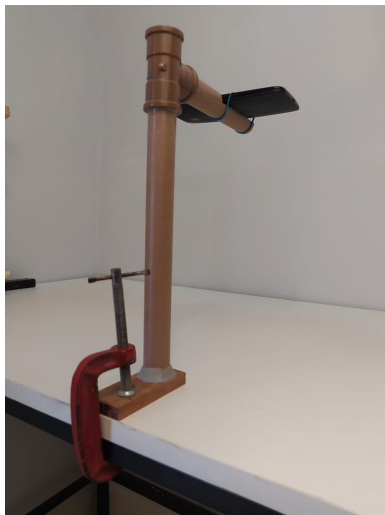
Figura 6. Suporte de cano de PVC para animação de mesa ou bancada. Fotografia do autor.
