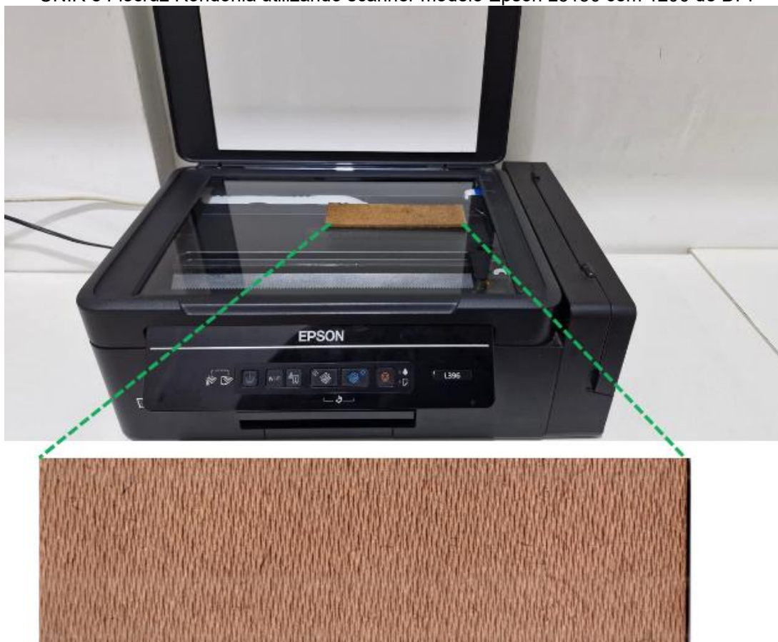
Figura 3 – Modo de captura das imagens para processamento provenientes de palhetas contendo ovos de Aedes spp. coletados no Campus José Ribeiro Filho da Universidade Federal de Rondônia-UNIR e Fiocruz Rondônia utilizando scanner modelo Epson L3150 com 1200 de DPI
