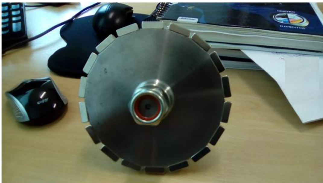
Figura 17– Montagem dos ímãs no rotor do gerador eólico.
