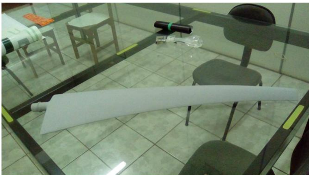
Figura 15– Molde da pá em material composto (superior) e cubo da pá (inferior).
