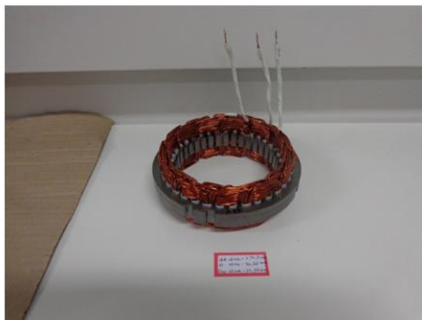
Figura 2 - Enrolamentos do estator do gerador comercial.
