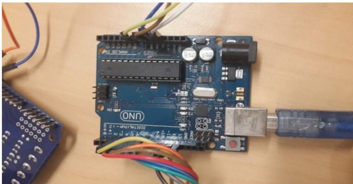
Figura 2 – Plataforma aberta Arduino Uno R3 utilizado no protótipo do carro.
