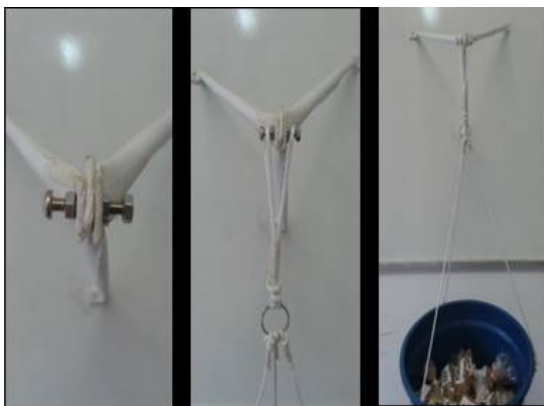
Figura 9 – Esquema do teste de carga.
