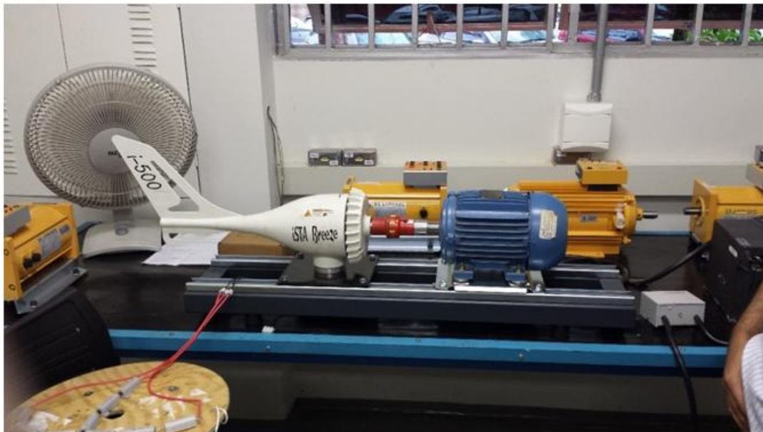
Figura 12: Bancada montada para levantamento de superfície de potência
