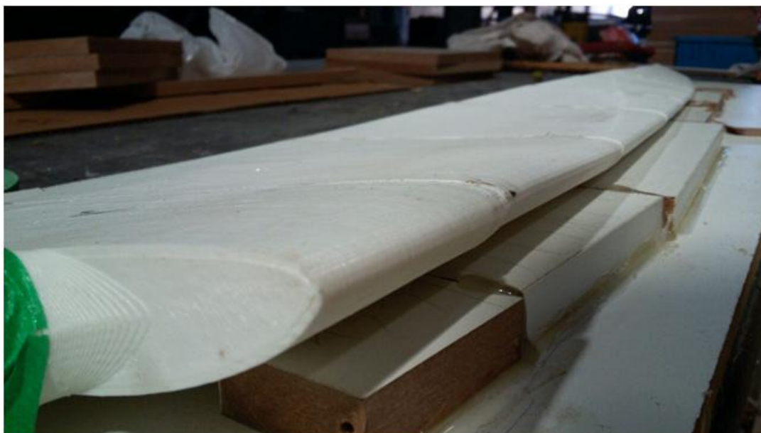
Figura 14–Montagem do molde para construção da pá em material composto.
