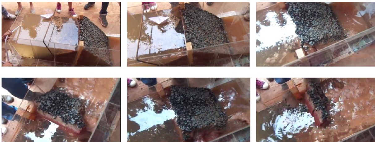
Figura 6 - Teste de ruptura da barragem / Equipe Geoquim. Fonte: GEOCOMPET (2014).
