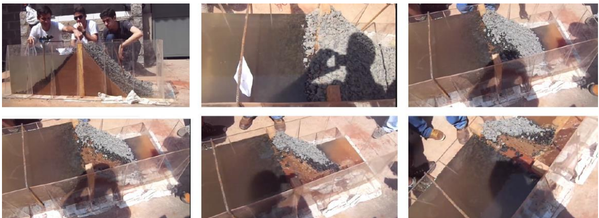
Figura 7 - Teste de ruptura da barragem / Equipe Forninhos. Fonte: GEOCOMPET (2014).
