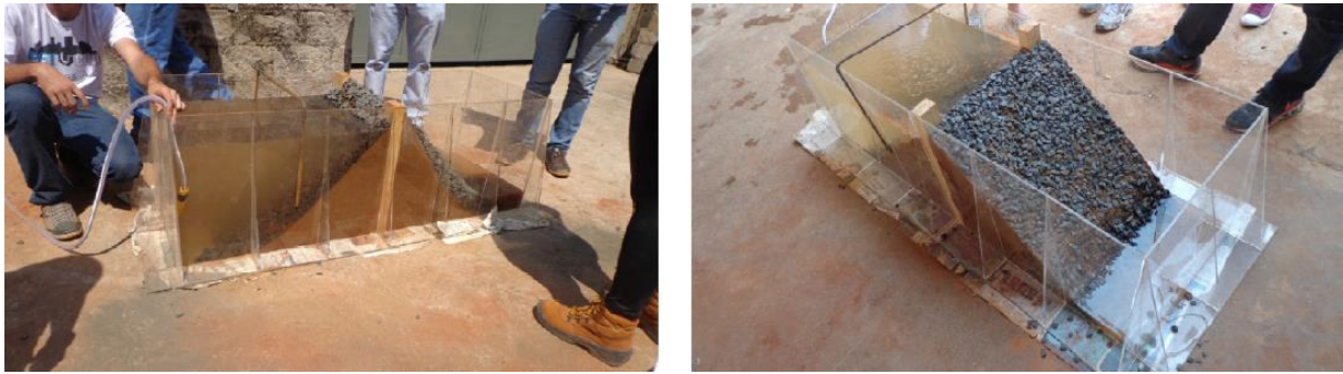
Figura 5 - Teste de percolação da água. Fonte: GEOCOMPET (2014).
