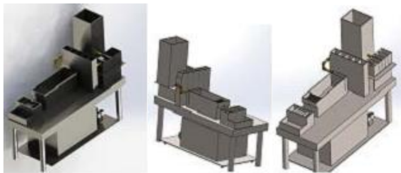
Figura 2 – Versão preliminar da unidade de tratamento de água virtual – construída em SolidWorks.
