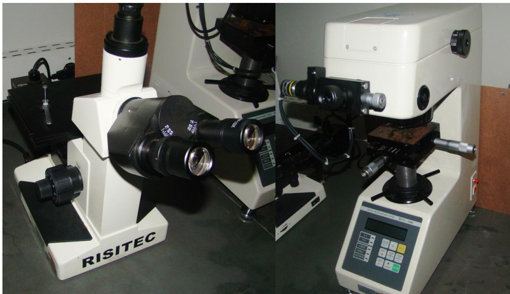
Figura 2.3 – Microscópio Metalúrgico e Microdurometro usado nas análises.
