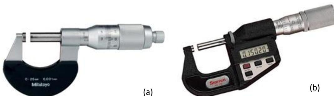
Figura 5. Micrômetro analógico (a) e micrômetro digital (b) (Mitutoyo (a) e Starrett (b)).
