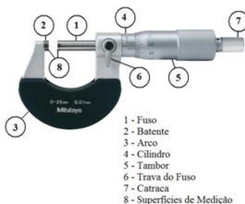
Figura 1. Componentes do micrômetro para medições externas (Mitutoyo).
