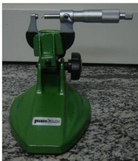
Figura 4. Suporte para micrômetros (Pantec).
