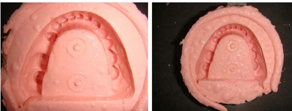
**Figuras 7 e 8.** Moldes após 10 min. e 30 min. de imersão, respectivamente. Observa-se o aumento de bolhas positivas, proporcionais ao tempo de imersão.
