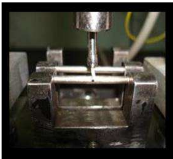
Figura 4: Teste de resistência Flexural de três pontos.
