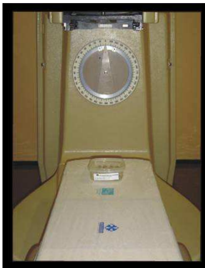
Figura 2: Irradiação das amostras com Gama Cobalto- 60, 2Gy/dia.
