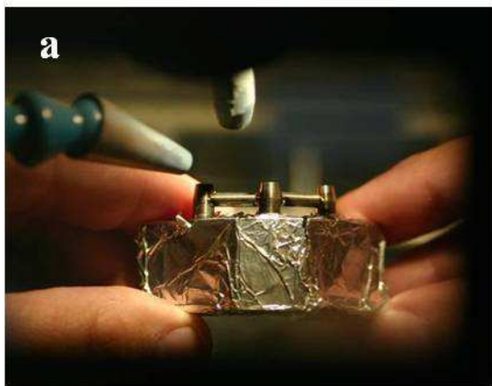
Figura 04: a) Soldagem LASER; b) Aspecto das barras soldadas aos pilares de titânio.
