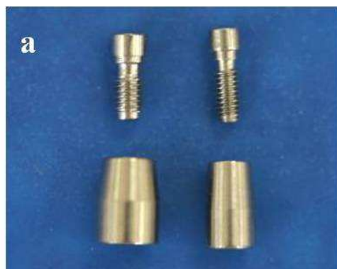
Figura 03: a) Pilares UCLA Titânio de 5 e 4,1mm de diâmetro respectivamente; b) Barras de Titânio de 3mm de diâmetro.
