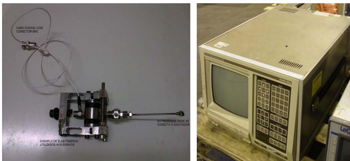
Figura 3 – Ensaios com ruído branco: dispositivo viscoelástico e Analisador SD380.
