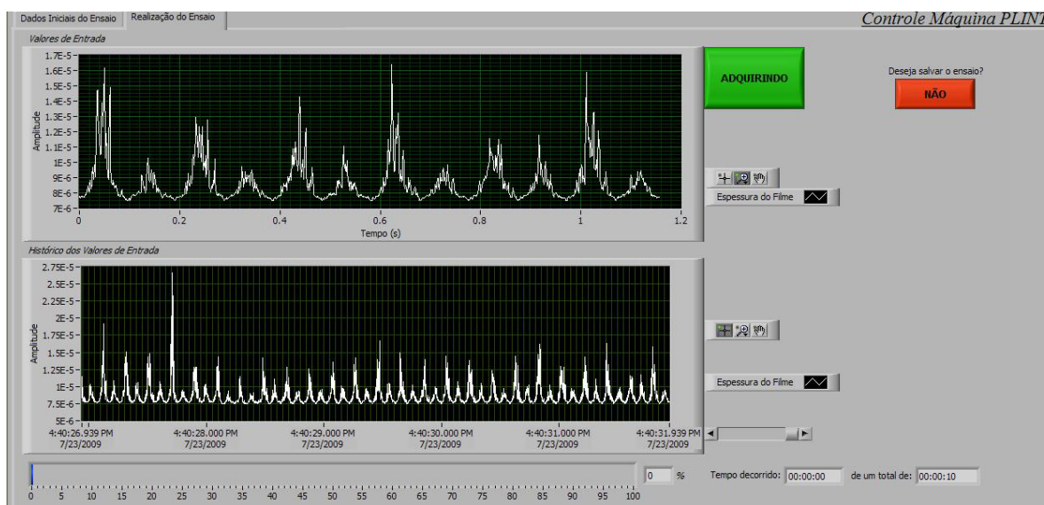
Figura 13 – Gráficos mostrando valores da espessura do filme de óleo, gerados durante a realização de um ensaio.
