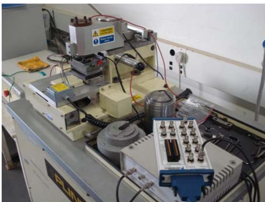
Figura 10 – Máquina PLINT com módulo BNC-2110 e sensor de medição de capacitância utilizados na realização do ensaio.
