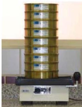
Figura 9- Conjunto de peneiras granulométricas sobre um vibrador para gesso.
