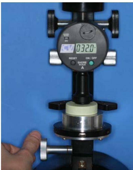
Figura 7– Durômetro para verificação da dureza *shore A*.
