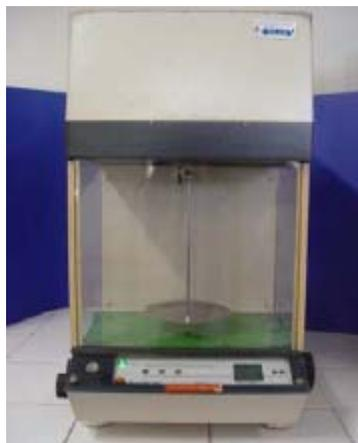
Figura 10- Balança analítica (Sauter Kg Ebinguen-Alemanha).
