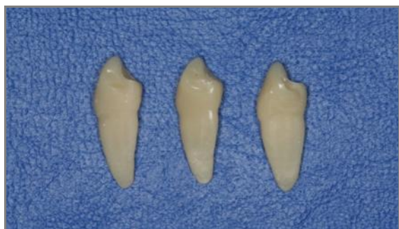
Figura 8. Dentes replicados em resina acrílica que foram utilizados nos modelos fotoelásticos.
