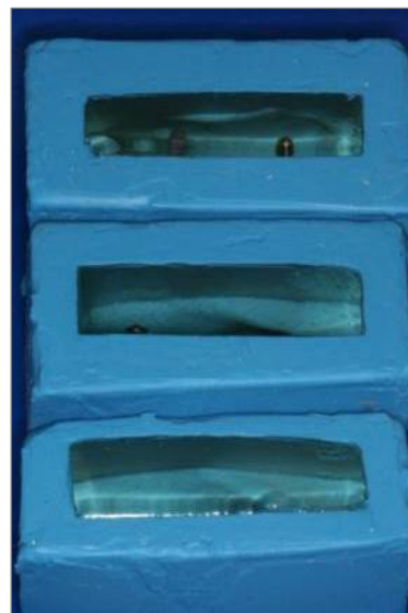
Figura 20. Matrizes com a resina fotoelástica flexível vertida em seu interior para obtenção dos modelos fotoelásticos MF1, MF2 e MF3.
