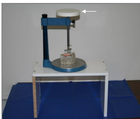
Figura 25. Conjunto delineador/suporte de madeira utilizado nos testes. Notar plataforma para a carga (seta).
