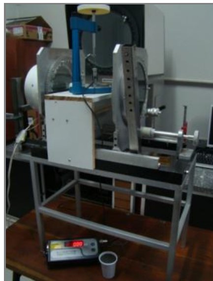
Figura 32. Sistema de aplicação de carga posicionado no polariscópio circular de transmissão plana e medidor de tensão.
