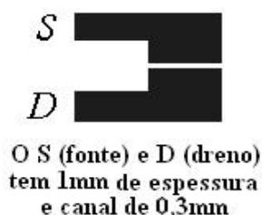
**Figura 16. Layout 1 do dispositivo.**
