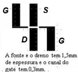
**Figura 17. Layout 2 do dispositivo.**
