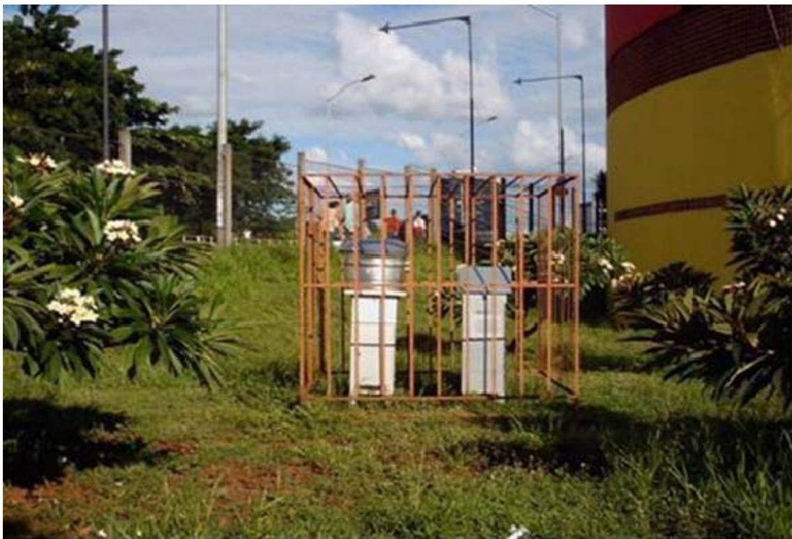
**Figura 3** – Amostradores de grandes volumes: AGV-PTS à direita e AGV-MP10 à esquerda.
