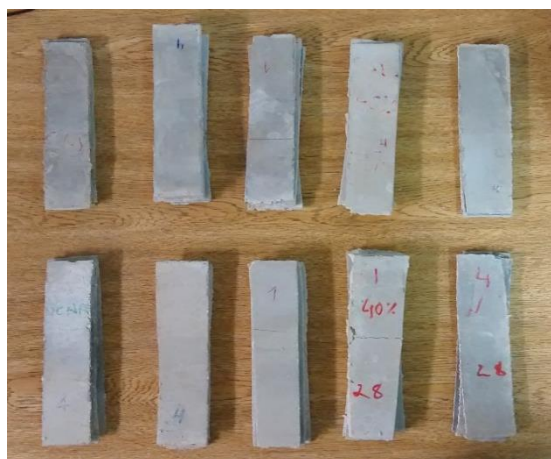
Figura 7: Corpos de prova para ensaio de flexão dos compósitos.
