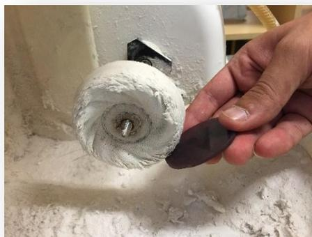
**Figura 17** – Polimento dos corpos de prova.
