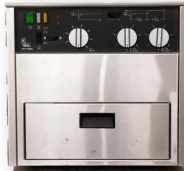
**Figura 13** – Máquina termopolimerizadora.
