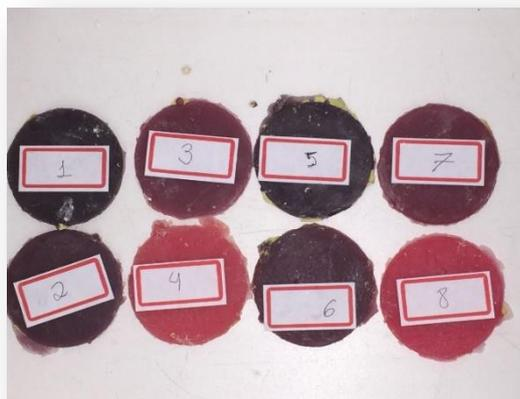
**Figura 15** – Identificação dos corpos de prova após a remoção dos mesmos das muflas.
