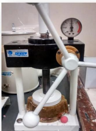
**Figura 11** – Prensagem com prensa hidráulica.
