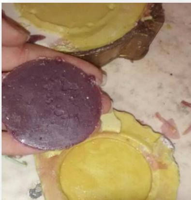
**Figura 14** – Remoção dos corpos de prova das muflas.
